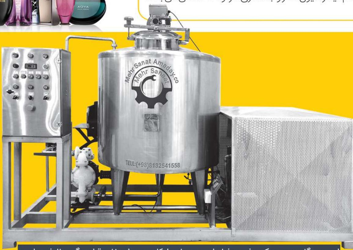
این دستگاه جهت میکسر فریز و فیلتراسیون عطر و ادکلن مورد استفاده قرار میگیرد، ظرفیت این دستگاه ۲۰۰ تا ۱۰۰۰ لیتر ساخته می شود، قدرت برودتی دستگاه تا دمای ۱۰- درجه می باشد.
